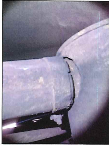
Local: Chassi Item # 36: silencioso do escape quebrado, soltando fuligem. Status: corrigido .
